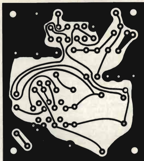
Fig. 3 - Basetta a circuito stampato vista dal lato ramato dei collegamenti in grandezza naturale.
